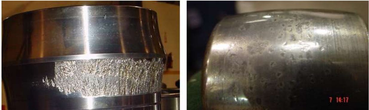
Bild 6: Schaden am Planetenlager, Innenring und Laufkörper
